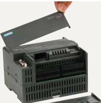
卸掉端子盖板
